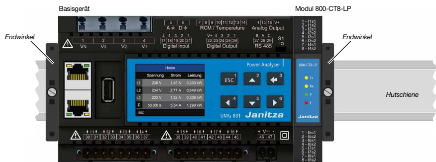
Abb. Montage-Beispiel: Frontansicht Basisgerät mit gekoppeltem Modul 800-CT8-LP
