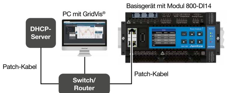
Abb.-Beispiel: PC-Verbindung mit DHCP-Server und PC
